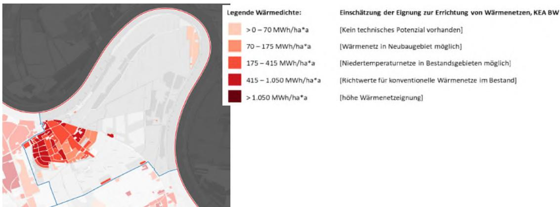
Abbildung: Wärmedichten auf Baublockebene im Teilgebiet
