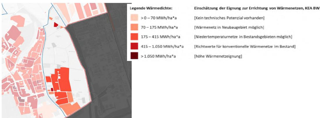
Abbildung: Wärmedichten auf Baublockebene im Teilgebiet
