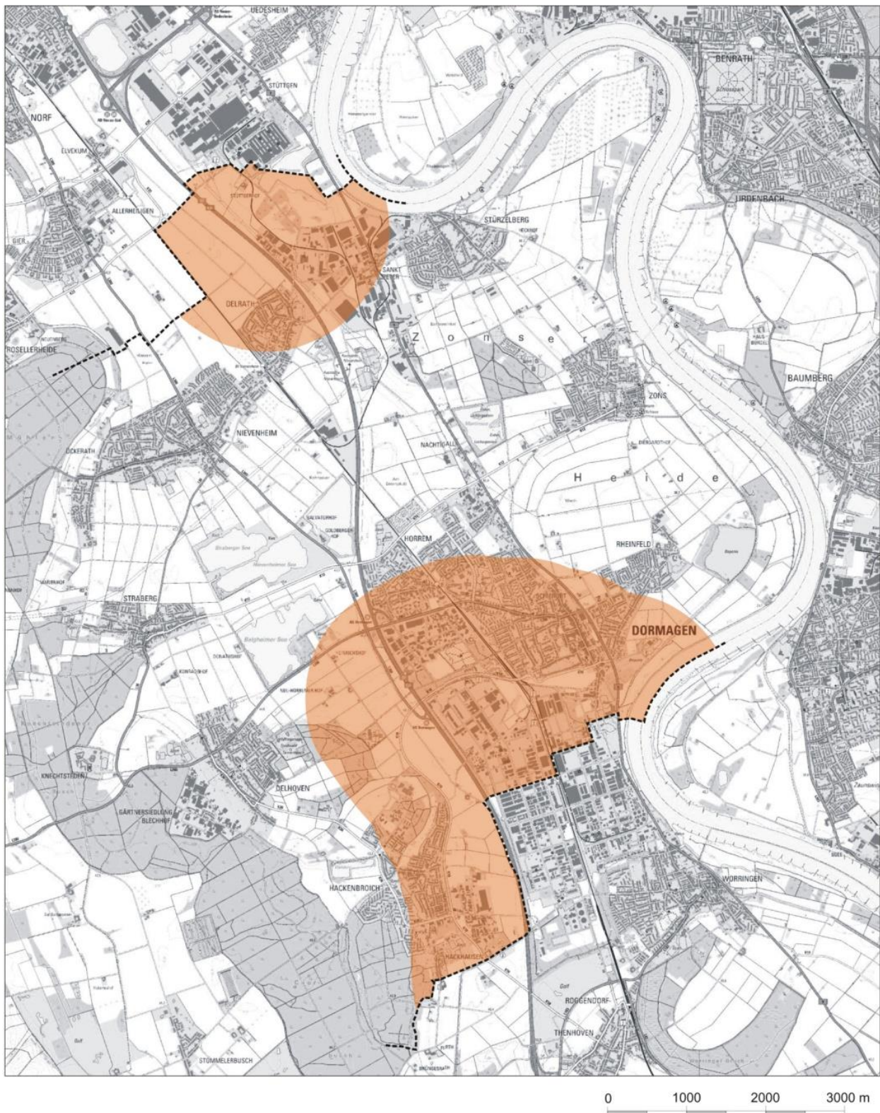
Abbildung 2: Pauschale räumliche Achtungsabstände (ohne Detailkenntnisse) der Betriebsbereiche / Anlagen nach Störfallverordnung im Stadtgebiet Dormagen
