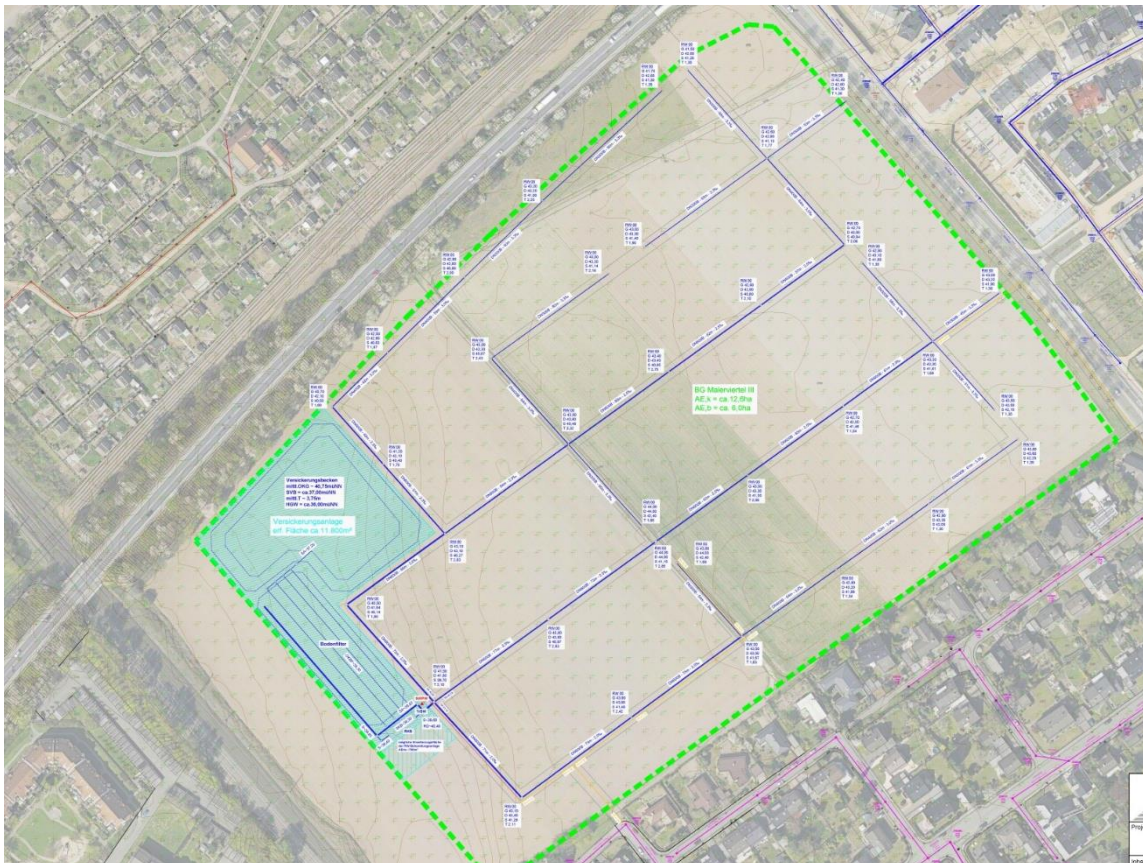
Ableitung und Beseitigung des Regenwassers
